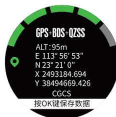
定位界面📍图标闪烁代表正在搜索卫星，定位成功后显示坐标数据，搜星过程中会实时显示搜星的卫星信号状况，卫星信号详情定义如下：
