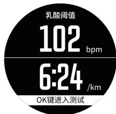
乳酸阈是指运动时人体的供能方式由有氧供能为主而转入由无氧为主供能的转折点，以乳酸阈速度或者心率进行运动可以有效提高人体的有氧工作能力，本设备通过监测显示乳酸阈时的配速和心率，为科学训练提供参考依据。
